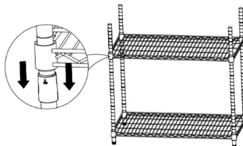
④ Verbind de bovenste palen (C) met de onderste palen (B) door de twee delen aan elkaar te schroeven via het schroefdraad dat reeds op de bovenste palen aanwezig is.
