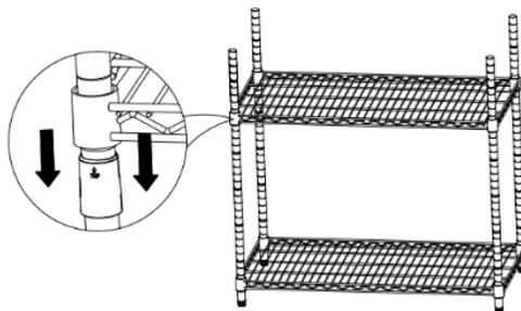
④ Connectez les poteaux supérieurs (C) aux poteaux inférieurs (B) en vissant les deux parties ensemble en utilisant les filets déjà présents sur les poteaux supérieurs.
