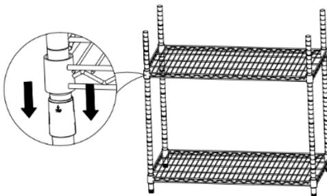
④ Verbinden Sie die oberen Pfosten (C) mit den unteren Pfosten (B), indem Sie die beiden Teile mit den bereits an den oberen Pfosten vorhandenen Gewinden zusammenschrauben.
