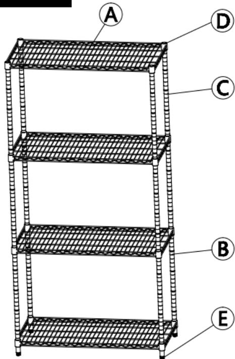
① Schrauben Sie die Nivellierfüße (E) in die Unterseite der vier unteren Pfosten (B). Lassen Sie die Kunststoffclips (D) in die Pfostennuten der vier unteren Pfosten (in derselben Position) einrasten und achten Sie darauf, dass der Pfeil auf den Kunststoffclips nach oben zeigt.
