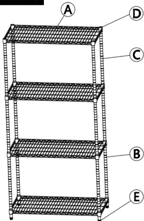
① Vissez les pieds de nivellement (E) dans le bas des quatre poteaux inférieurs (B). Enclenchez les clips en plastique (D) dans les rainures des quatre piliers inférieurs (dans la même position) en vous assurant que la flèche sur les clips en plastique pointe vers le haut.
