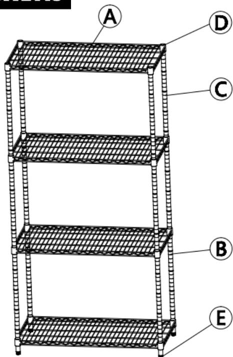
① Schroef de stelvoeten (E) in de onderkant van de vier onderste palen (B). Klik de plastic clips (D) in de paalgroeven van de vier onderste palen (op dezelfde positie) en zorg ervoor dat de pijl op de plastic clips naar boven wijst.
