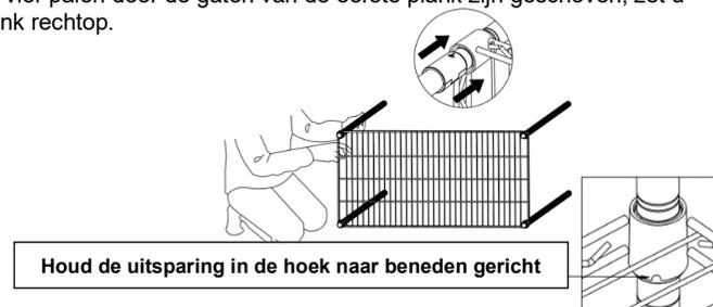
③ Klik de plastic clips in de groeven van de onderpalen op de gewenste plankhoogte/positie. Schuif de plank van boven naar beneden in de plastic clips.
