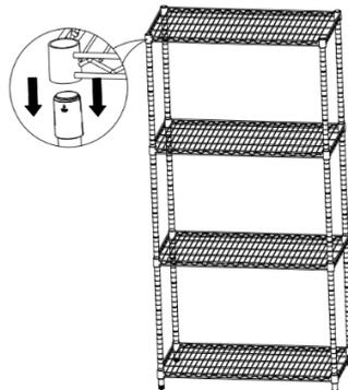
⑥ Wenn alle Dielen angebracht sind, schlagen Sie mit einem Gummihammer leicht auf jede Ecke jeder Diele, um sicherzustellen, dass die Diele fest über den Kunststoffclips sitzt. Schrauben Sie abschließend die verstellbaren Füße hinein oder heraus, um das Rack richtig zu nivellieren.
