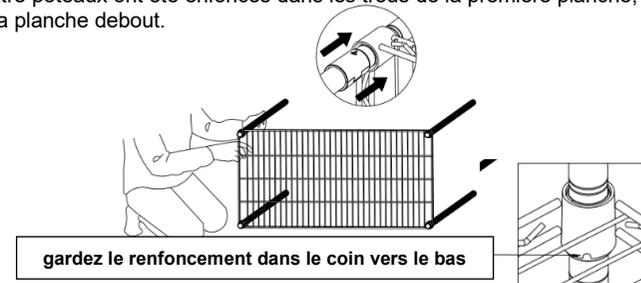
③ Enclenchez les attaches en plastique dans les rainures des montants inférieurs à la hauteur/position souhaitée de l'étagère. Faites glisser l'étagère dans les clips en plastique de haut en bas.
