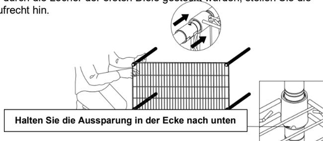
③ Rasten Sie die Kunststoffclips in die Nuten der Bodenpfosten in der gewünschten Regalhöhe/-position ein. Schieben Sie das Regal von oben nach unten in die Kunststoffclips.
