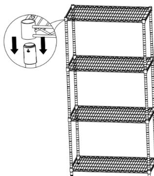
⑥ Zodra alle planken zijn geïnstalleerd, geeft u met een rubberen hamer een slag (gematigd) op elke hoek van elke plank om ervoor te zorgen dat de plank goed over de plastic clips zit. Schroef als laatste de stelvoetjes naar binnen of naar buiten om de stelling goed waterpas te stellen.
