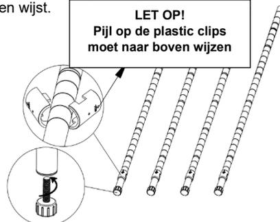
② Zorg ervoor dat de plank (A) met de juiste kant naar boven gericht is (houd de uitsparing in de hoek van de plank naar beneden gericht). Houd de plank op zijn kant en schuif de bovenkant van de vier onderste palen door de onderkant van elke plank in zijn hoek tot hij goed past. Nadat vier palen door de gaten van de eerste plank zijn geschoven, zet u de plank rechtop.
