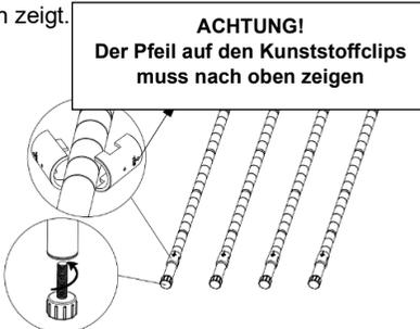
② Achten Sie darauf, dass das Regal (A) nach oben zeigt (halten Sie die Aussparung in der Ecke des Regals nach unten). Halten Sie das Regal auf der Seite und schieben Sie die Oberseite der vier unteren Pfosten durch die Unterseite jedes Regals an seiner Ecke, bis es fest sitzt. Nachdem vier Pfosten durch die Löcher der ersten Diele gesteckt wurden, stellen Sie die Diele aufrecht hin.
